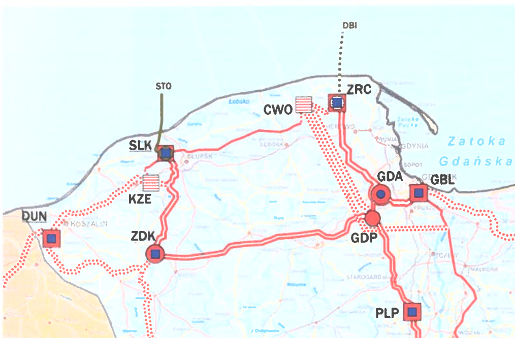
Rys. 2. Schemat połączeń sieci elektroenergetycznej najwyższych napięć z uwzględnieniem inwestycji planowanych do 2030 r. [4]
