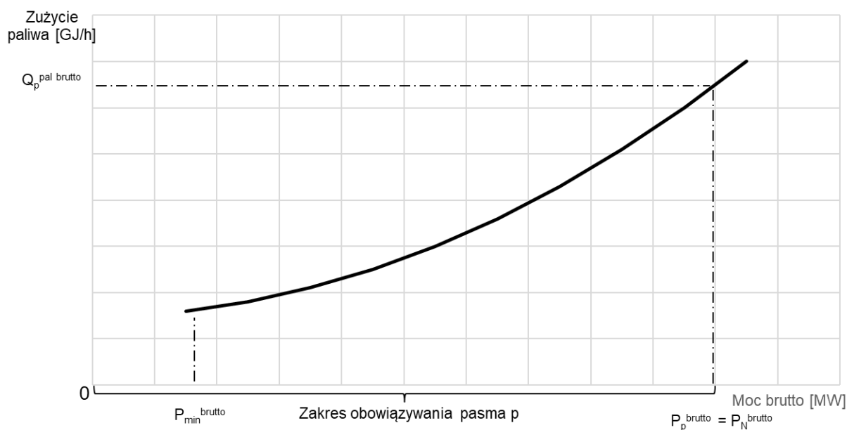
Rysunek 4.1. Ilustracja wyznaczenia współczynnika przemiany energii chemicznej paliwa w energię elektryczną brutto dla jednego pasma mocy p .
